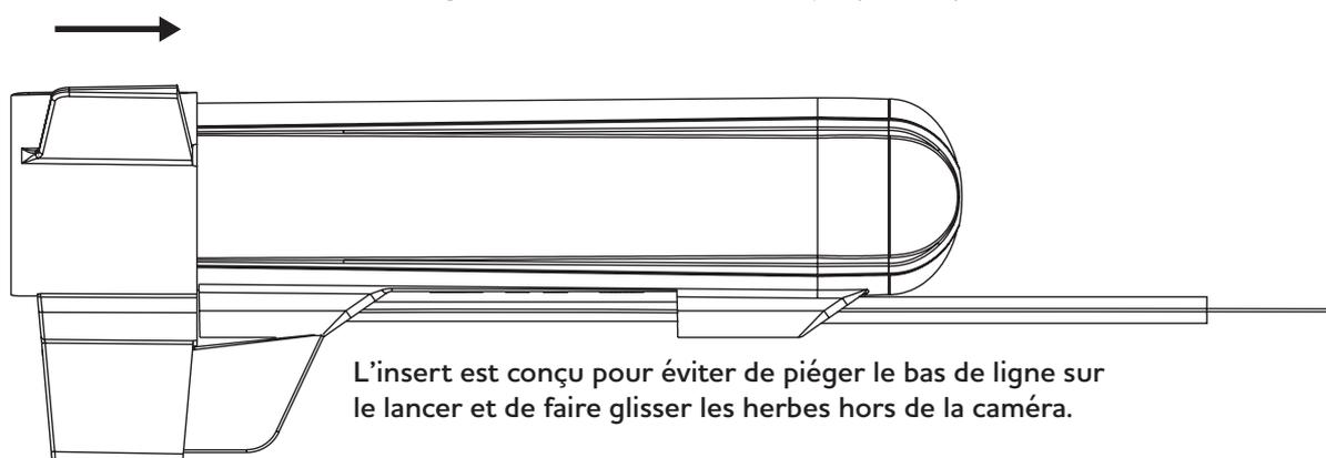
2. Assurez-vous ensuite que les deux petites protubérances sur les côtés de la caméra s'alignent sur les creux correspondants de l'aileron en Y, puis fermez le verrou. Il s'agit d'un ajustement serré qui nécessite la pression du pouce sur le verrou pour se fermer avec un clic audible.
