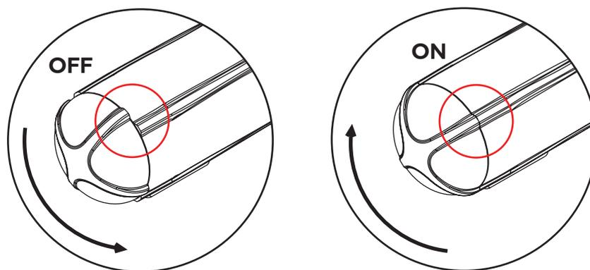
**Veuillez ranger l'appareil photo avec l'embout en position OFF.**
