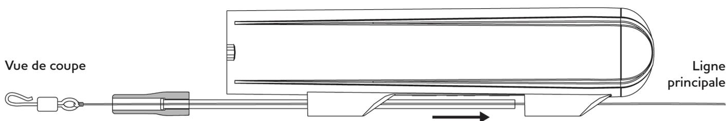
3. Faites glisser le tube à travers les tubes de guidage de manière à ce que l'embout en caoutchouc soit au même niveau que le tube de guidage. Assurez-vous que le côté plat de l'embout en caoutchouc repose sur le dessous de la caméra. Attachez ensuite le bas de ligne au crochet à changement rapide de l'émerillon. Soit en formant une boucle, soit en l'attachant. Tirez ensuite l'émerillon dans l'embout en caoutchouc en laissant la partie du crochet dépasser pour qu'il puisse tourner librement.
