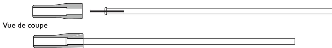
2. Enflez votre ligne principale à travers les tubes de guidage de la caméra. Enflez ensuite la ligne principale à travers le tube et l'embout en caoutchouc. Attachez la ligne principale à l'œillet de l'émerillon.
