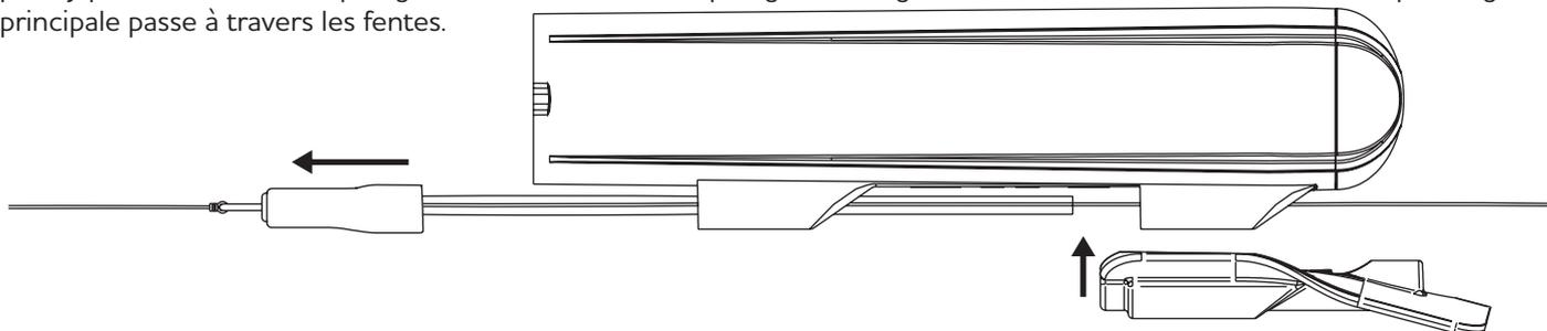
2. Faites glisser le tube jusqu'en arrière pour verrouiller la bavette de plongée en place.
