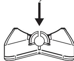
1. Pour monter la bavette de plongée, faites glisser le tube vers l'avant jusqu'à ce qu'il y ait un espace suffisamment grand pour y placer la bavette de plongée. Placez la bavette de plongée sur le guide arrière du tube en vous assurant que la ligne principale passe à travers les fentes.
