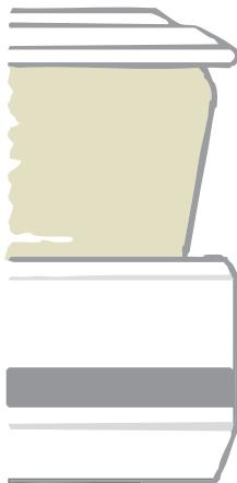
DER OBERE TEIL DER SPULE FASST MEHR SCHNUR ALS DER UNTERE TEIL MIT DER NUT. DIE SPULE SITZT ZU TIEF AUF DER HAUPTWELLE. UM DIES AUSZUGLEICHEN, FÜGE EINE UNTERLEGSCHEIBE HINZU.
