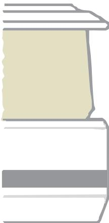
LE BAS DE LA BOBINE CONTIENT PLUS DE LIGNE QUE LE HAUT AVEC UNE RAINURE. LA BOBINE EST TROP HAUTE SUR L'ARBRE PRINCIPAL. POUR Y REMÉDIER, RETIREZ UNE RONDELLE.
