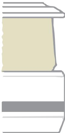
LA PARTE INFERIOR DEL CARRETE TIENE MÁS HILO QUE LA SUPERIOR CON RANURA. EL CARRETE ESTÁ DEMASIADO ALTO EN EL EJE PRINCIPAL. PARA CONTRARRESTARLO, RETIRA UNA ARANDELA.
